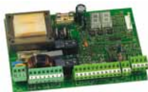
Плата управления 455 D Технические характеристики на странице 129
